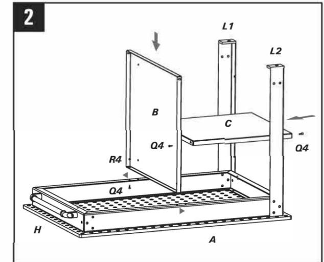
Installez le panneau de séparation (B) sur le cadre en utilisant 2 vis M6 x 16 (Q4) et des écrous M6 (R4). Notez que 2 trous de montage dans le cadre doivent être près du côté poignée(H).
