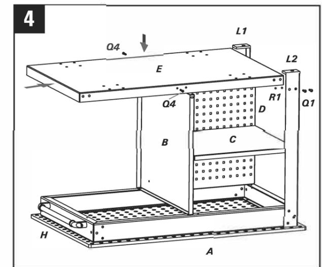
Installez le plateau inférieur (E) sur les 2 pieds de table en utilisant 4 vis à tête bombée M10 x 20 (Q1) et les écrous M10 (R1).
