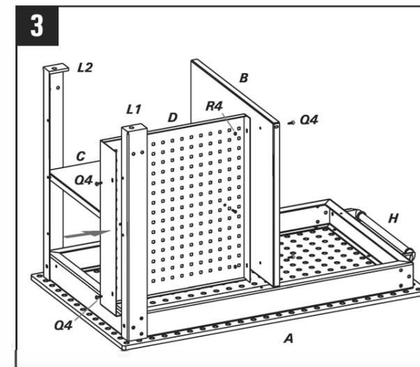
Installez le panneau perforé carré (jaune) (D) entre le panneau de séparation (B) et le pied de table (L1) en utilisant 4 vis M6 x 16 (Q4) et les écrous hexagonaux M6 (R4).
