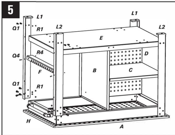
Installez les 2 autres pieds de table (**L1**) et (**L2**) sur le bord extérieur du cadre en utilisant 16 vis à tête bombée M10 x 16 (**Q1**) et les écrous M10 (**R1**).
