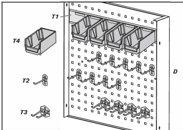
Pour utiliser les bacs à bec (**T4**), installez le support rack (**T1**) sur le panneau perforé carré (**D**). Ensuite, installez les bacs à bec (**T4**) sur le support rack (**T1**), installez les crochets simples (**T2**) & les crochets doubles (**T3**) sur le panneau perforé (**D**) selon vos besoins.
