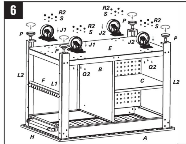
Installez les roulettes pivotantes à frein (**J1**) et fixe (**J2**) sur le plateau inférieur (**E**) avec 16 vis (**Q2**), (**S**) et (**R2**). Installez les 4 patins de nivellement (**P**) aux pieds de table (**L1** & **L2**). Serrez toutes les vis et les écrous. Enfin, placez soigneusement la table sur ses pieds. Ajustez les patins de nivellement (**P**) pour mettre à niveau la table.
